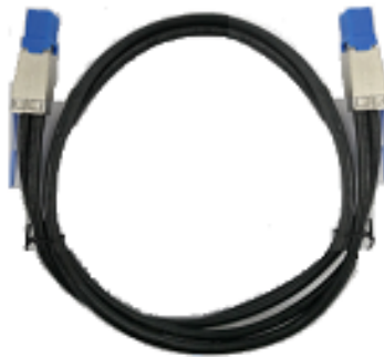
图4-40 安装防尘盖的 SAS 线缆示意图
