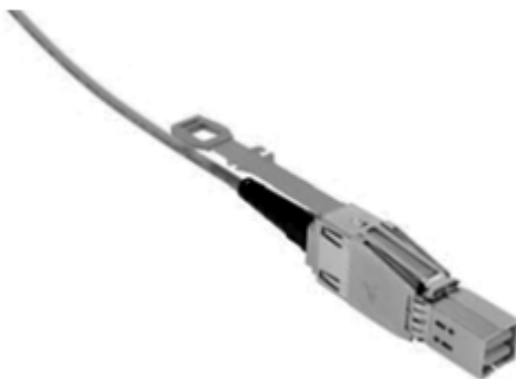
图4-35 D 类 SAS 线缆示意图
